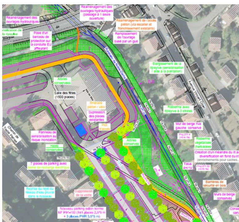
Cartographie avant-projet de création d'un méandre du ruisseau de Notre-Dame en aval de la salle des fêtes de Treize-Pierres (source : étude GEMAPI du bassin versant de Notre-Dame – CCE-C pour SMBV2A - 2022)
